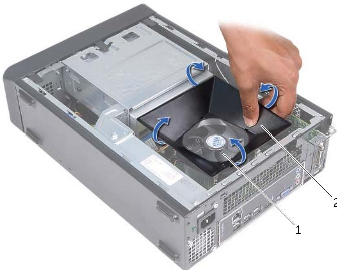
1 Prozessorlüfter- und Kühlkörperbaugruppe 2 Lüfterverkleidung
